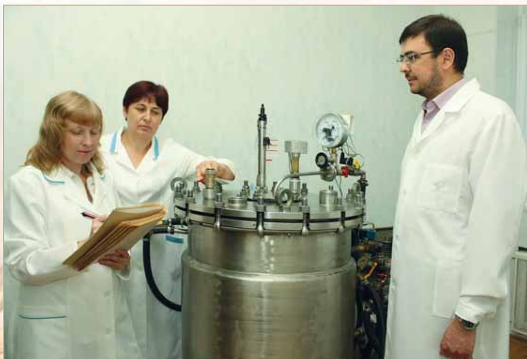
Рис. 1. Дослідження ростової активності діазотрофів у біологічному реакторі
