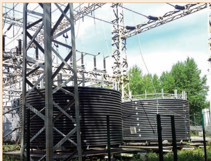
Испытания ВТСП кабеля постоянного тока длиной 860 м
