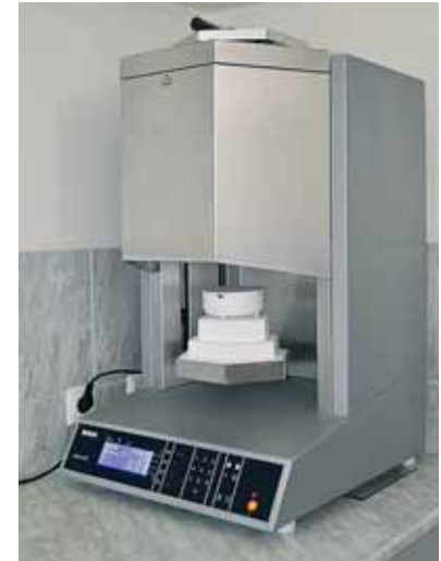
SIRONA inFire HTC — високотемпературна агрегаційна піч для всіх реставрацій, які обробляються на апаратах inLab. Достатньо лише обрати необхідну програму та задати час обробки
