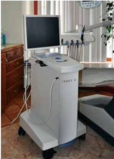
CEREC 3 — модульна комп'ютерна реставраційна система. Дозволяє лише за одне відвідування виготовити високоякісну конструкцію безпосередньо біля крісла пацієнта або в зуботехнічній лабораторії
