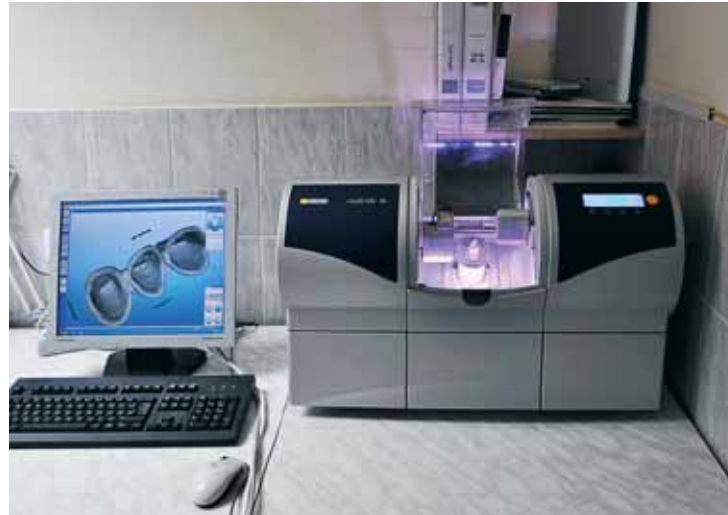
SIRONA inLab MC XL — високотовиробничий шліфувальний блок. Має великий спектр оброблюваних матеріалів та забезпечує високу точність шліфування за мінімальний час
