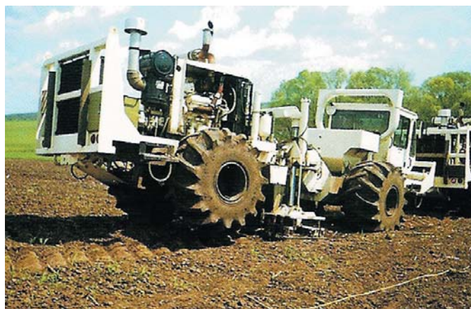
Вібраційні системи для збудження сейсмічних коливань
