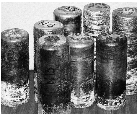
Злитки високоочищеного титану, отримані методом камерного електрошлакового переплаву
