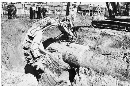
Змінне обладнання до екскаватора для підкопування ґрунту під трубопроводами
