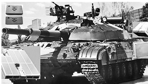
Танк БМ «Булат» із ДЗ «Ніж»
