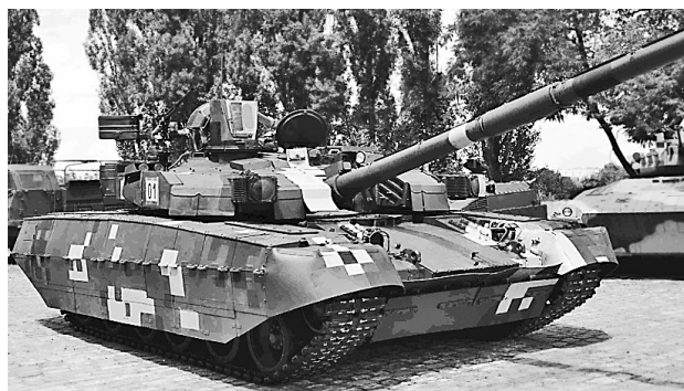
Танк БМ «Оплот» із вбудованим протитандемним динамічним захистом «Дуплет»
