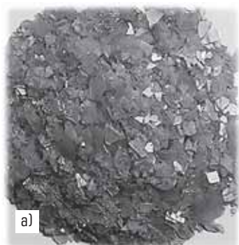
Коолігомер, одержаний: а) емульсійною коолігомеризацією; б) ініційованою полімеризацією (промисловий метод)
