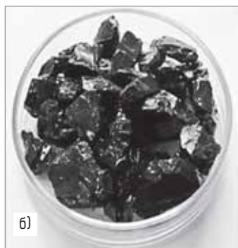
Коолігомер, одержаний: а) емульсійною коолігомеризацією; б) ініційованою полімеризацією (промисловий метод)
