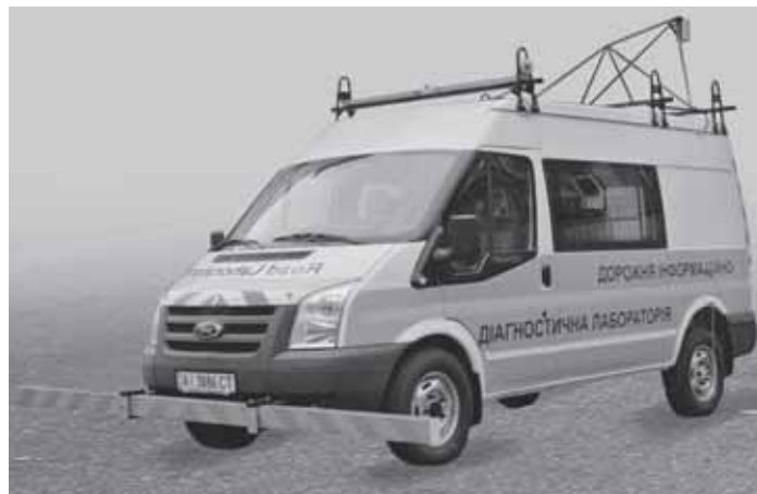
Діагностична пересувна лабораторія для оцінки стану дорожніх покриттів
