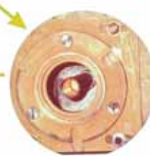
Світловодний пристрій (стаціонарно встановлений у футерівку міксера, іммерсійним торцем в контакт з розплавом)
