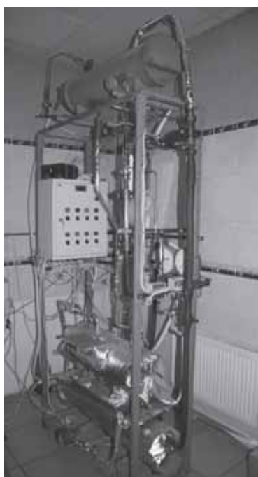
Експериментальний стенд автономної ежекторної холодильної машини
