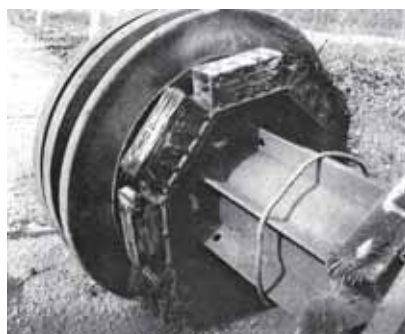
Магнітні системи (ліворуч) лабораторії НДЛ-13 на поршні ДУ 1420 мм після проходження дільниці магістрального газового трубопроводу КС Козова-Долина та продукти очистки газової труби (праворуч)
