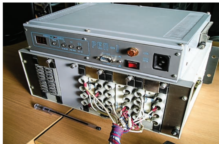
Багатоканальний реєстратор електричних параметрів аварійних процесів мережі типу РЕП
