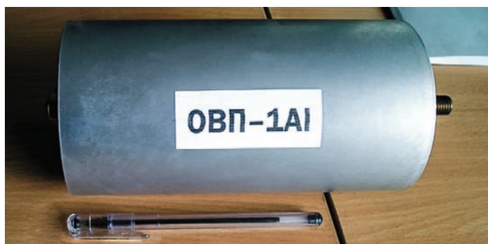
Одноканальний вимірювальний перетворювач параметрів електроенергії
