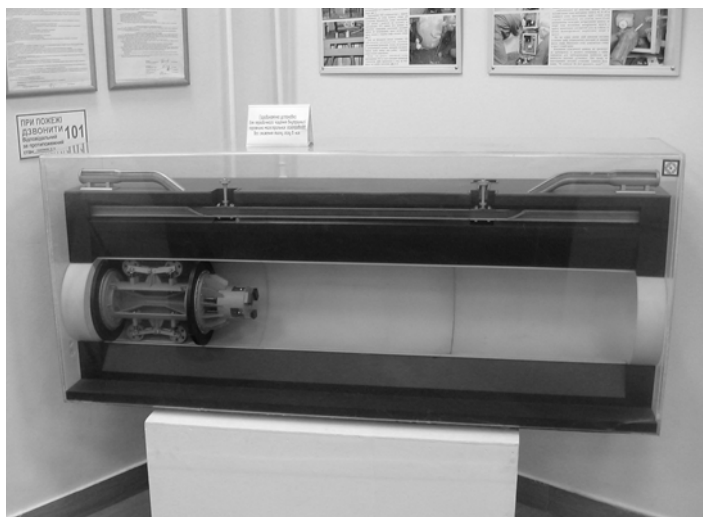
Газодинамічна установка для очищення внутрішньої порожнини газопроводів
