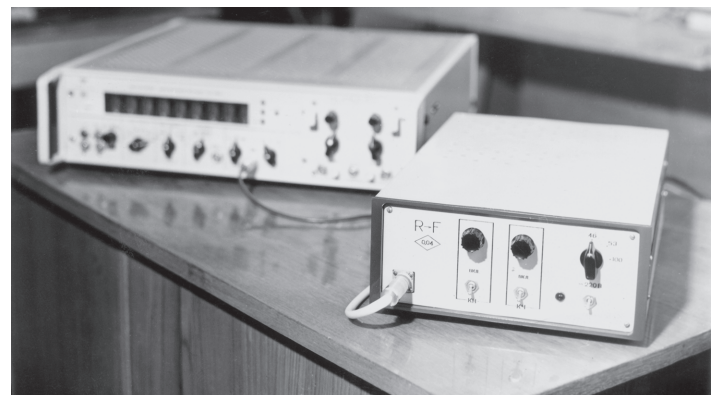
Установка для автоматизованої перевірки термометрів опору при їх серійному виробництві
