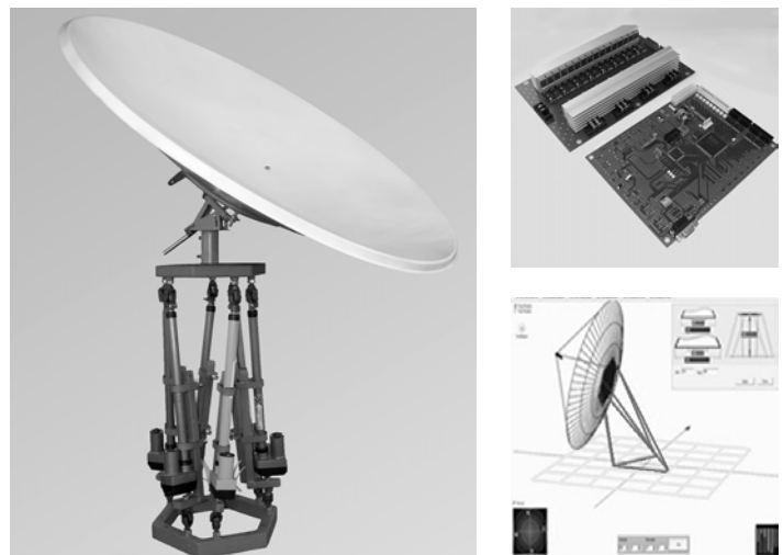
Рис. 4. Експериментальна АС, її модель з ОПП Нехарод та електроніка керування
