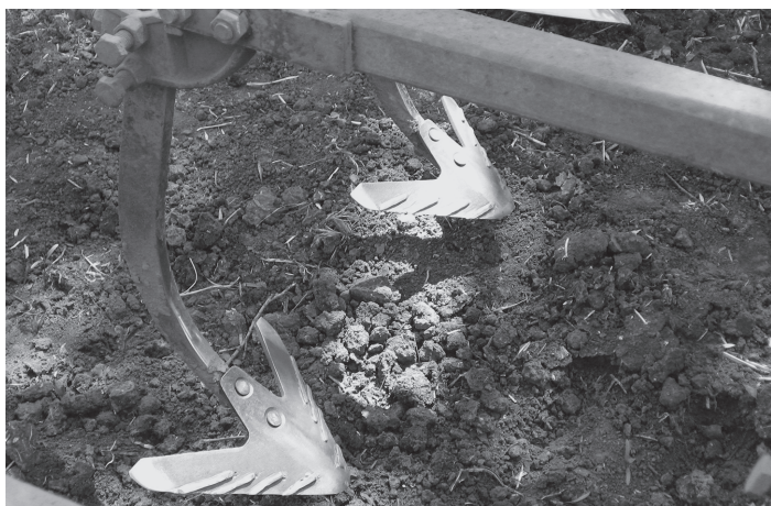
Культиватор КПС-4, обладнаний культиваторними лапами з елементами локального зміцнення
