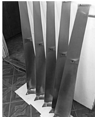
Лопатки турбін з покриттям «Avinit» (ПАТ «Турбоатом», м. Харків)
