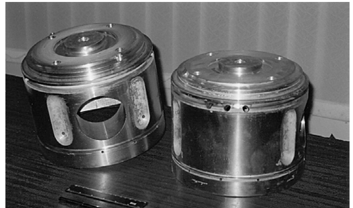
Нанокompозитні покриття «Avinit» на поршнях дизелів типу Д80 (ДП «Завод імені Малишева», м. Харків)
