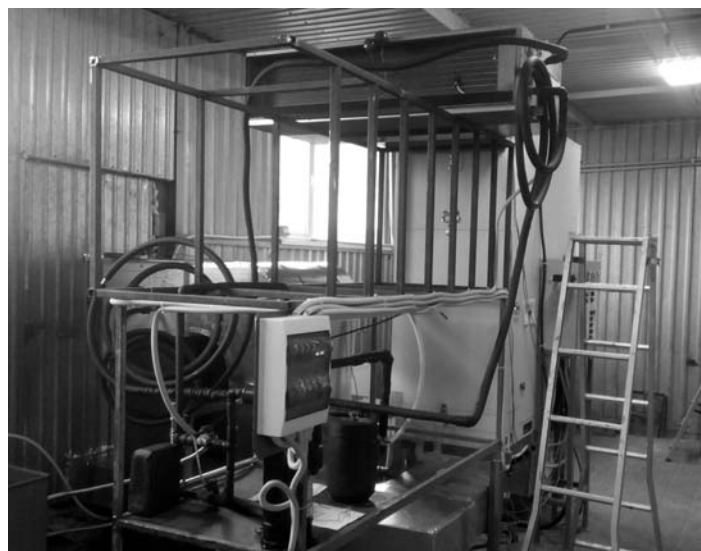
Суперекфективний тепловий насос із потужністю 28 кВт (теплових)
